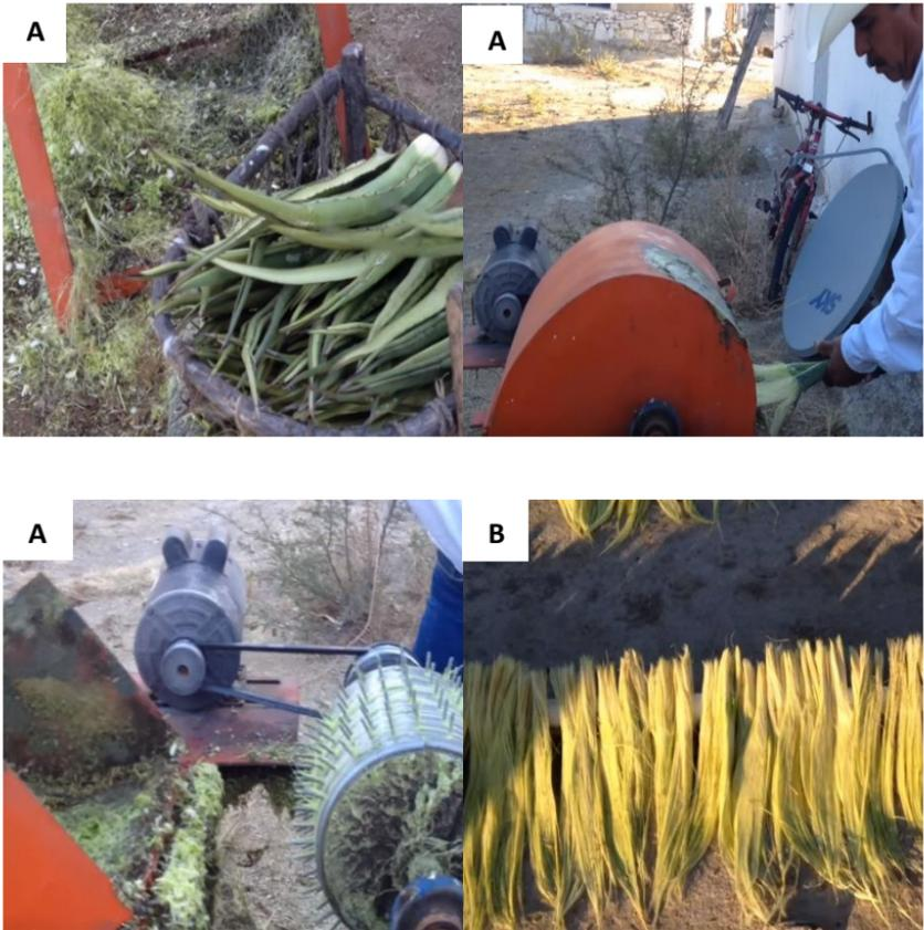
**Figura 6.** A) Tallado mecánico de los cogollos. B) Fibra o ixtle de *Agave lechuguilla* Torr., producto del tallado mecánico.
